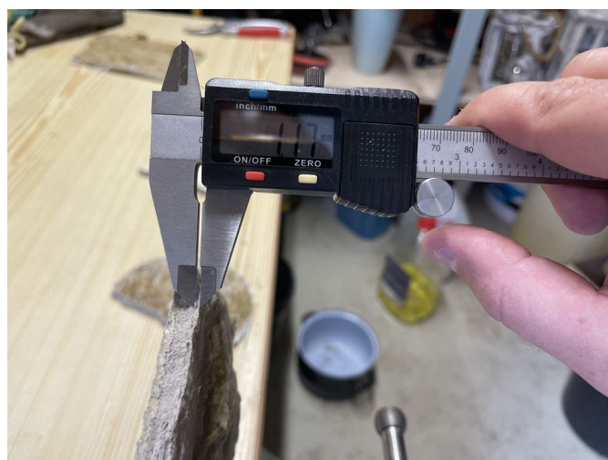
foto /20/ Měření polohy výztužné tkaniny vzorku ze sondy S2 (1,2 mm ze strany interiéru)
