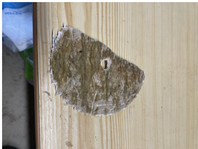
foto /16/ Prosvítající výztužná tkanina ze strany interiéru ve vzorku ze sondy S1
