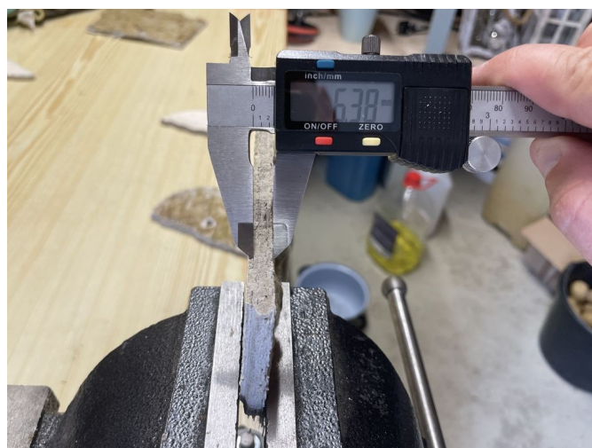
foto /18/ Tloušťka základní vrstvy v místě sondy S2 (6,4 mm)
